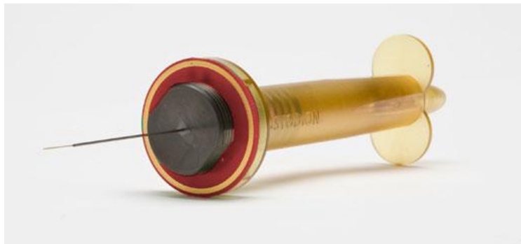
Слика 1.13. Пакување со силиконаски влакна за цврсто-фазна микро екстракција
