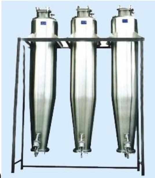
Слика 1.6. Перколатори со голем капацитет за индустриска екстракција.
